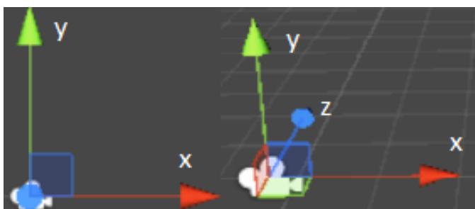
Joonis 20. Vector2 (vasakul) ja vector3 (paremal) näiliselt kaamera suhtes.
