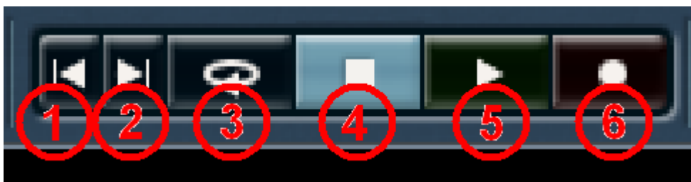
Joonis 10. Transpordinupud. 1 – projekti algusesse liikumine, 2 – lõppu liikumien, 3 – esituse kordamine, 4 – esituse peatamine, 5 – esitamine, 6 – lindistamine.
