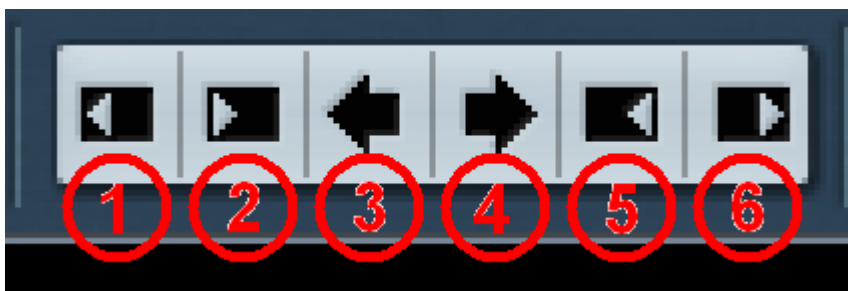
Joonis 13. Nudge Palette . 1 – heliregiooni alguse pikendamine, 2 – alguse lühendamine, 3 – regiooni nihutamine vasakule, 4 – nihutamine paremale, 5 – heliregiooni lõpu lühendamine, 6 – lõpu pikendamine.
