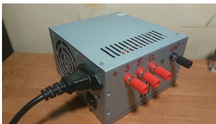
Illustratsioon 3.2: Toiteplokk, väljundid
