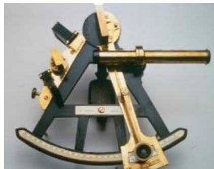
Joonis 2. H. Limbach'i ilus eebenipuust Sekstant.
