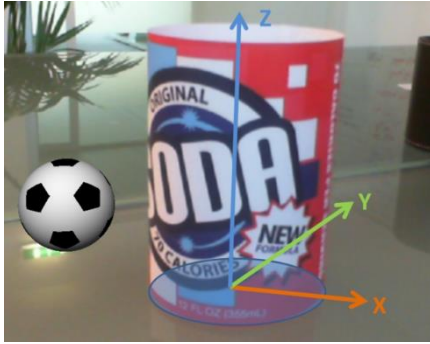
Joonis 17. Silindrilise objekti kasutamisest markerina. Mõõtude arvestamine x, y ja z telge pidi 16
