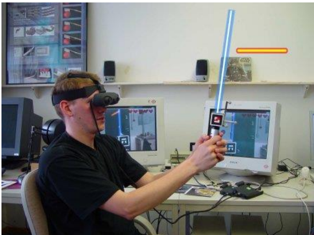
Joonis 28. Kasutatakse multimarker -it (kuubikut) laseri positsioneerimiseks. Kasutusel on peakomplekt 27
