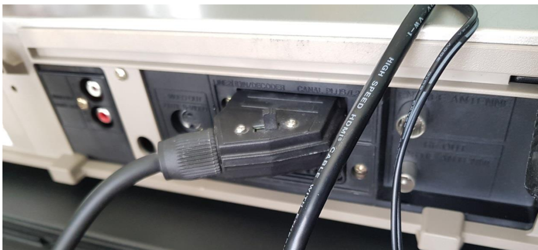
Joonis 2. Videomagnetofoni ühendamisvõimalused
